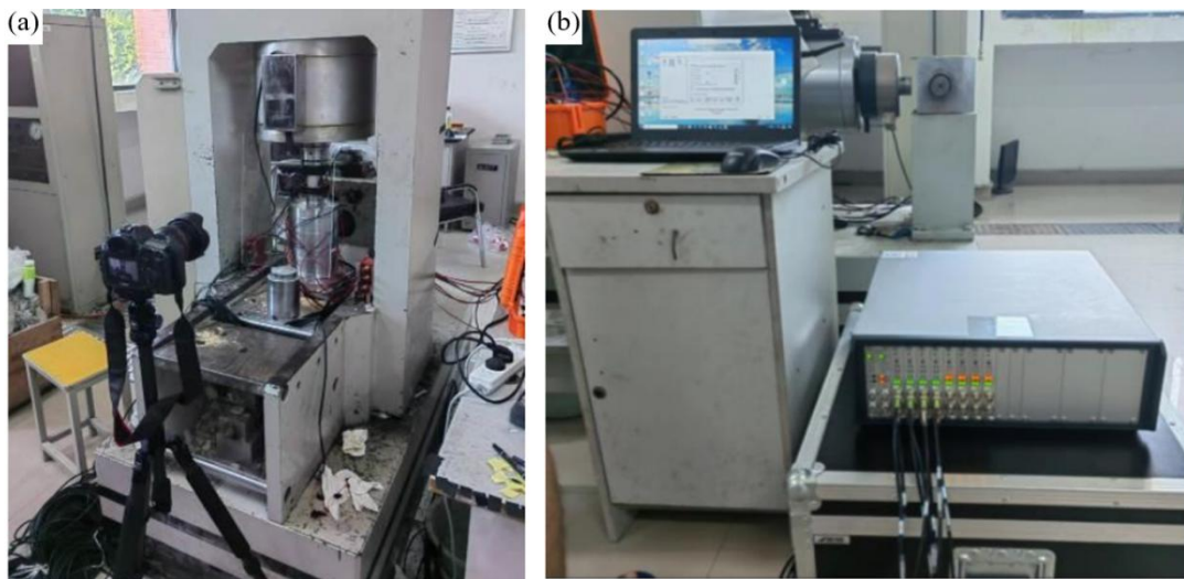
图 1 隧道围岩试样单轴加载试验 (a) DIC 高速摄像；(b) 声发射监测
