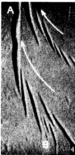
图 1, 2. 两个帚状构造,按箭头所指方向转动纸面产生的。
