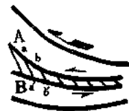
图 4 两个旋迴层相对扭动方向与其间所夹的砸细薄层中片理排列的关系(剖面图)
